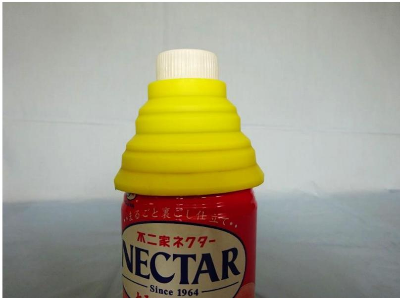
この「かんぺとる」はふたを一度開けると閉めることのできない缶の容器でも、ペットボトルと同じように何度でもふたを開け閉めできるようにするための道具です。この道具の内側にある赤い部分を缶の飲み口のわくにはめて使います。黄色い部分はゴム製の折りたたみ式のコップでできでいて、その内側にもう一つのゴム製のろうとの一部をつなぎ合わせることで缶にフィットし、液体がこぼれないようになっています。また飲み口のペットボトルの部分は取り外して洗うことができます。
