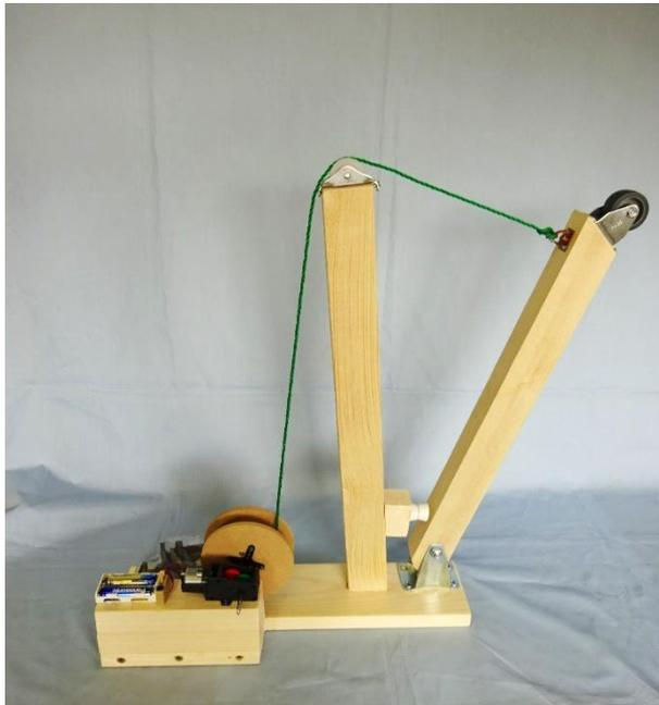
この作品は自動で窓を閉めてくれる装置です。時間が経つと自動で窓を閉めてくれるので、コロナ禍で換気をしたい時や冬の夜に加湿をして結露した時など、外出時にも防犯しながら空気の入れ替えが出来ます。また、寝る時に窓を開けていても朝には窓が閉まっているので、寝冷えも防止出来ます。
