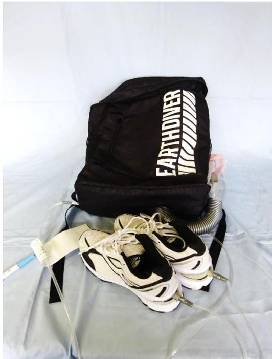
この作品のポイントは、「保冷バックの中の冷気をいかに効率的に目的の排気口から送風させるか」です。
