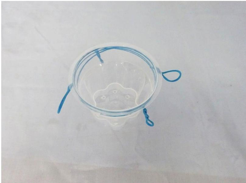
新型コロナウイルスの感染防止には手洗いが重要ですが、せっかく石鹸できれいに手を洗っても、水を止める際に蛇口を触ることで再び手にばい菌が付着すると思いました。そこで、蛇口を閉めた後でも一定時間は水が流れ続ける仕組みを考えました。水の出口にタンクを設け、蛇口を閉めた後はタンクから水が流下することで手を洗い流せるようにしました。食品の空き容器に穴を開けたものをタンクとし、4つの輪ゴムでどのような蛇口にもタンクを安定して固定できるようにしました。
