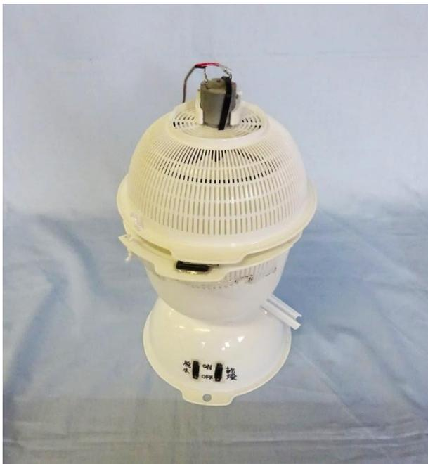
母が生ゴミを捨てる時、重くて臭いがきついため困っていました。そのため、生ゴミから水分を取り除いて、乾燥した無臭で虫が寄らない軽い生ゴミにすることができる装置を作りました。この構造は洗濯機のように回転させる方法に加えて、ドライヤーのように風を当てる方法で生ゴミをより早く乾燥させる工夫をしました。効果としては、1回の食事が出る生ゴミを13g減らすことができます。これは1年間で約14kgもの生ゴミを減らすことができることとなります。
